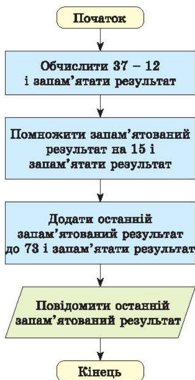
Рис. 1.20. Блок-схема алгоритму обчислення значення виразу 73 + (37 - 12) \cdot 15
