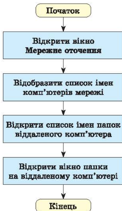
Рис. 5.8. Блок-схема алгоритму здійснення навігації локальною мережею
